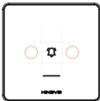
دو قسمت مشخص شده در شکل مقابل را به مدت ۵ ثانیه نگه‌دارید تا بوق ریست را شنیده و چراغ دستگاه به حالت چشم‌کزن سریع درآید. دستگاه شما ریست شده است.
